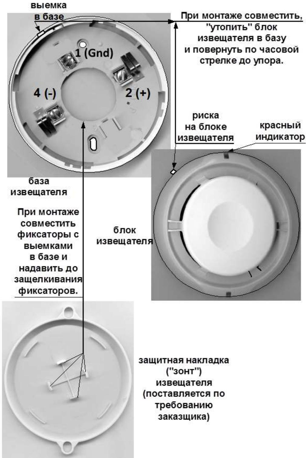
Рис. 1 АТИ (база, блок извещателя, "зонт")
