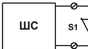
Рис. 13 Подключение извещателя с НЗ контактами без контроля целостности ШС
